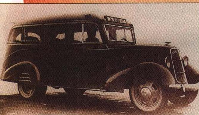
5. А это лаборатория по ремонту и обслуживанию высоковольтных сетей на шасси «ГАЗ-03-30». Такие лаборатории в 1938-1940 г. работали в Мосэнерго. Фото с разрешения Е.С.Бабурина
