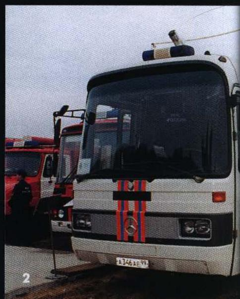
Помимо прочего автомобиль оснащен воздухохранилищем емкостью 100 л и компрессором высокого давления... Осветительная мачта высотой 6 м. Мощность прожекторов – 2 кВт.
