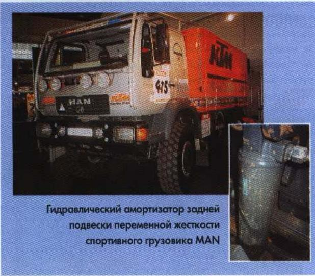
**Гидравлический амортизатор задней подвески переменной жесткости спортивного грузовика MAN**
