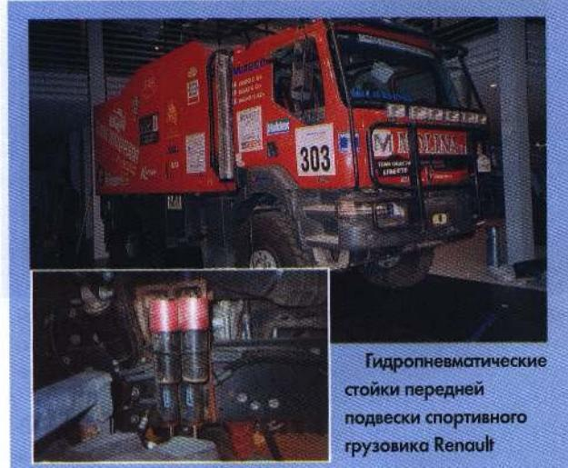
Гидропневматические стойки передней подвески спортивного грузовика Renault
