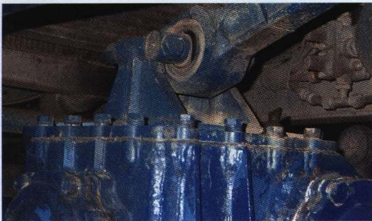
**Дополнительная реактивная тяга на крышке картера редуктора – защита от скручивания моста**
